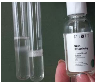
Рисунок 2 – Результат реакции кислоты гиалуроновой Scin Chemistry с цетилпиридиния хлоридом (пробирка слева; пробирка справа – белая опалесценция растворилась в 10% растворе хлорида натрия)
