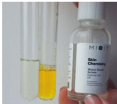
Рисунок 4 – Результат реакции препарата кислоты гиалуроновой Scin Chemistry с молибденованадиевым реактивом (пробирка справа)
