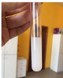
Рис. 2. Осадок хлорида серебра – продукт реакции лидокаина гидрохлорида с нитратом серебра в азотнокислой среде
