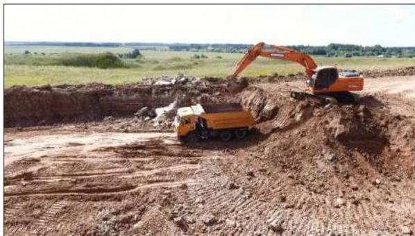
Рис. 1. Разработка карьера для добычи глины
