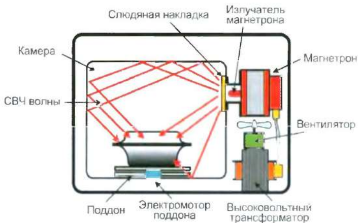
Рис. 1 Устройство СВЧ-печи
