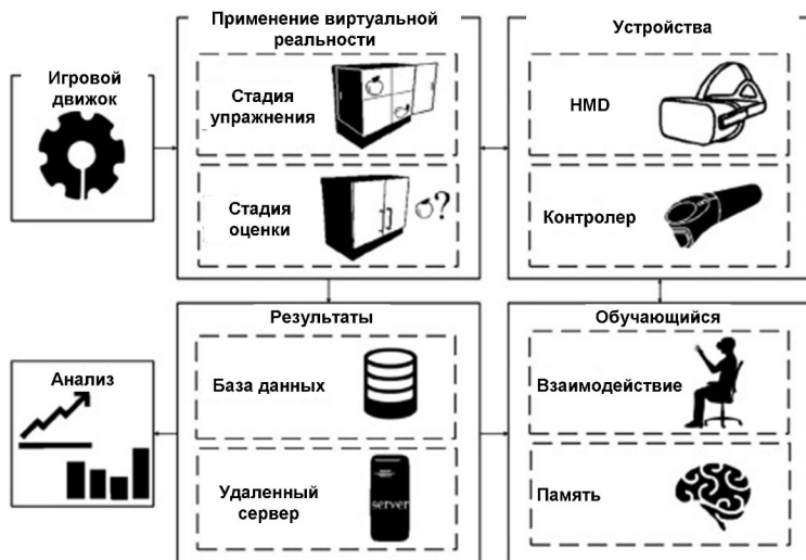
Рисунок 3 – Общая схема системы на основе погружающей виртуальной реальности (IVR) [7]
